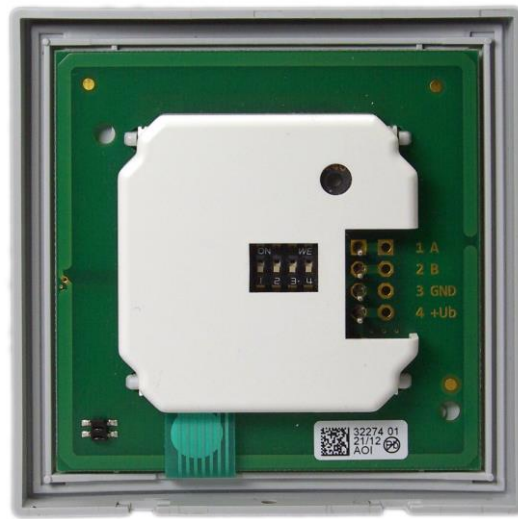
Lesemodul Rückseite ohne Federleiste
