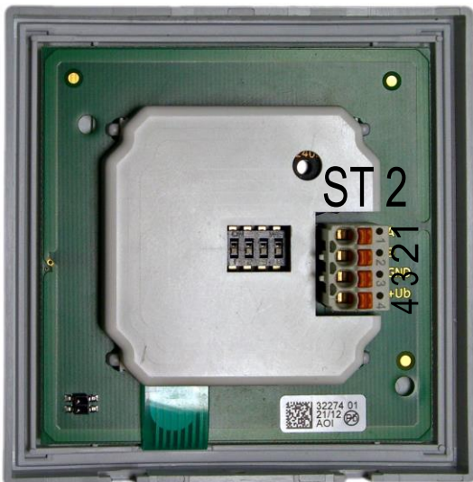
Lesemodul Rückseite mit Federleiste
