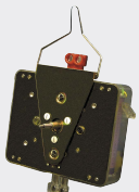
Nebenuhrwerk 4112, Sekunde und Minute springend, Innen bis 60cm, Dreilochbefestigung, besonders geräuscharm
