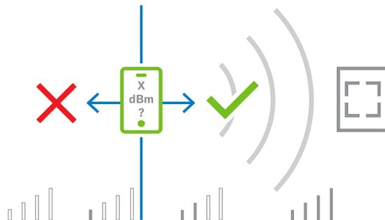
Die RSSI-Werte können stark variieren, was von vielen Faktoren abhängt, z. B. von der Art des Sendegeräts, dem Batteriestand sowie dem Material und der Dicke der Wände in der Nähe. Es gibt keine lineare Beziehung zwischen dem RSSI-Wert und der Entfernung zwischen Sender und Empfänger.
