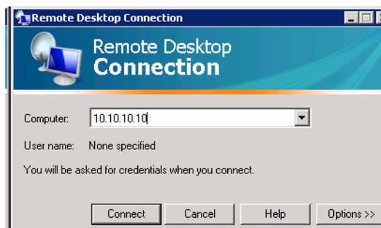
3. **Connect** をクリックし、 **Ctrl+Alt+Del** が表示される場合はこれを押します。ディスクアレイのログインウィンドウが表示されたらデフォルトパスワード **WSS4Bosch** を入力します。
