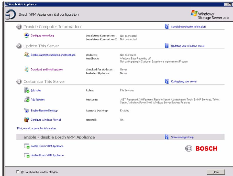
5. Widok najwyższego poziomu okna **Bosch VRM Appliance initial configuration** przedstawia konfigurację i ustawienia systemu. Kliknij łącze **Configure networking**, aby przejść do konfiguracji sieci. Każdy port sieci jest przedstawiony jako osobna ikona. Wybierz ikonę **Local Area Connection**, przy której jest podany status **network**, a następnie kliknij ją dwukrotnie.
