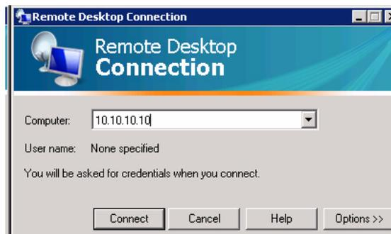
3. Haga clic en **Connect**, pulse **Ctrl+Alt+Del** (si se muestra) y, a continuación, escriba la contraseña predeterminada **WSS4Bosch** cuando aparezca la ventana de inicio de sesión del array de discos.
