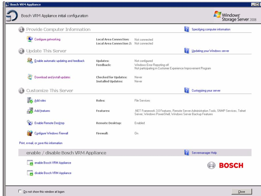
5. La vista del nivel superior de **Bosch VRM Appliance initial configuration** muestra un resumen de la configuración y los ajustes del sistema. Seleccione el enlace **Configure networking** para acceder a la configuración de red. Aparecerá un icono de cada uno de los puertos de red. Seleccione el icono de **Local Area Connection** que muestra el estado **network** y, a continuación, haga doble clic en el icono.
