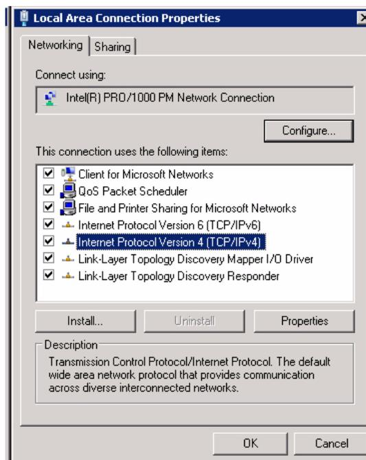
6. 该对话框允许您根据网络要求设置 IP 地址配置。
