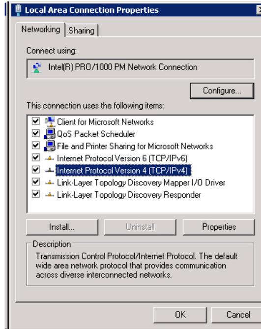
7. 该对话框允许您根据网络要求设置 IP 地址配置。
