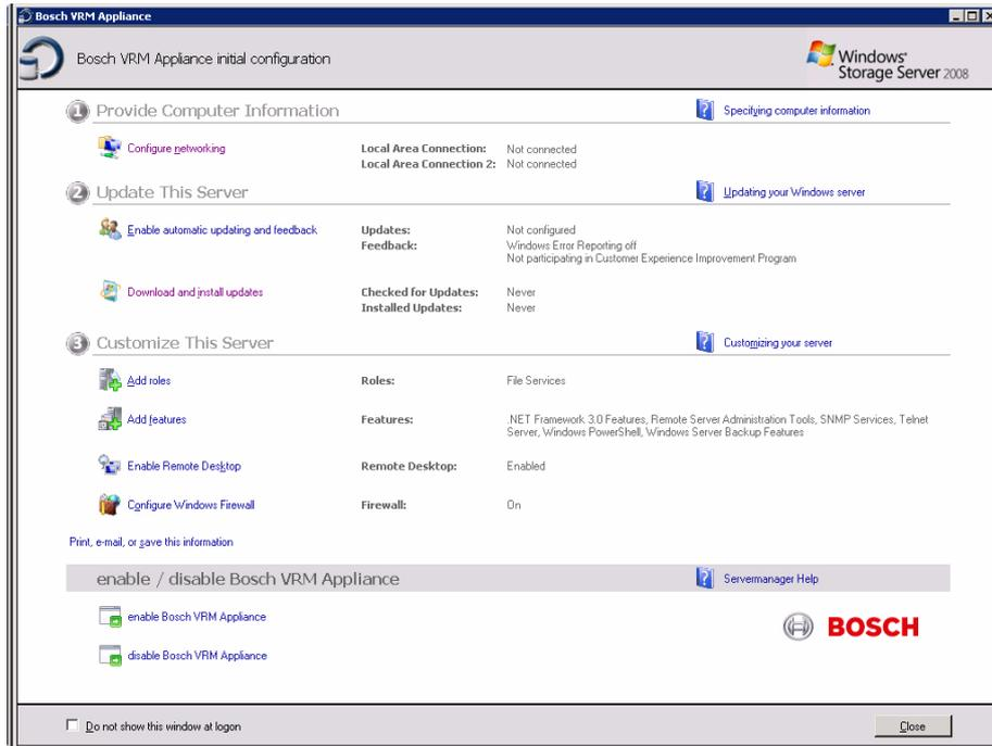
5. **Bosch VRM Appliance initial configuration** 的顶层视图概要显示了系统的配置和设置。选择链接 **Configure networking** 以访问网络配置。对于每个网络端口，均会显示单独的图标。选择用于显示状态 **network** 的 **Local Area Connection** 图标，然后双击图标。
