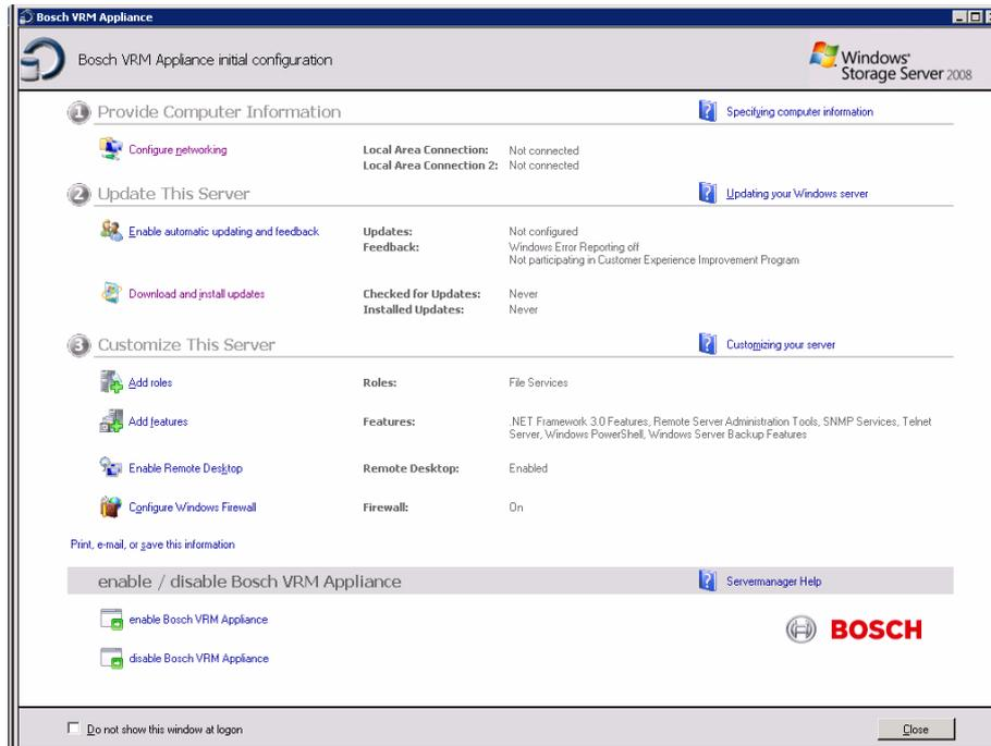
5. La parte superiore della schermata **Bosch VRM Appliance initial configuration** riporta una panoramica della configurazione e delle impostazioni del sistema. Selezionare il collegamento **Configure networking** per accedere alla configurazione di rete. Per ciascuna porta di rete, viene visualizzata un'icona separata. Selezionare l'icona **Local Area Connection** indicante lo stato **network**, quindi fare doppio clic sull'icona.
