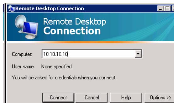
3. Klicken Sie auf **Connect**, drücken Sie **Ctrl+Alt+Del** (falls angezeigt), und geben Sie dann, sobald das Anmeldefenster des Disk-Arrays angezeigt wird, das Standardpasswort **WSS4Bosch** ein.
