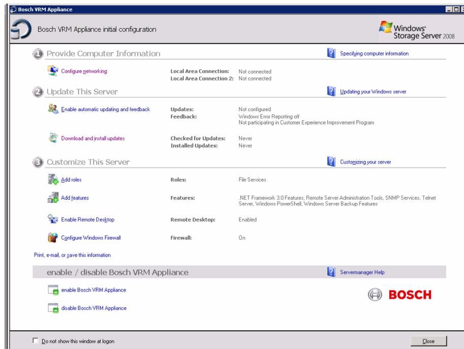
4. A vista de nível superior da **Bosch VRM Appliance initial configuration** apresenta uma descrição geral das configurações e definições do sistema. Selecciona a ligação **Configure networking** para aceder à configuração de rede. É apresentado um ícone em separado para cada porta de rede. Selecciona o ícone **Local Area Connection** que apresenta o estado **network** e, em seguida, faça duplo clique no ícone.
