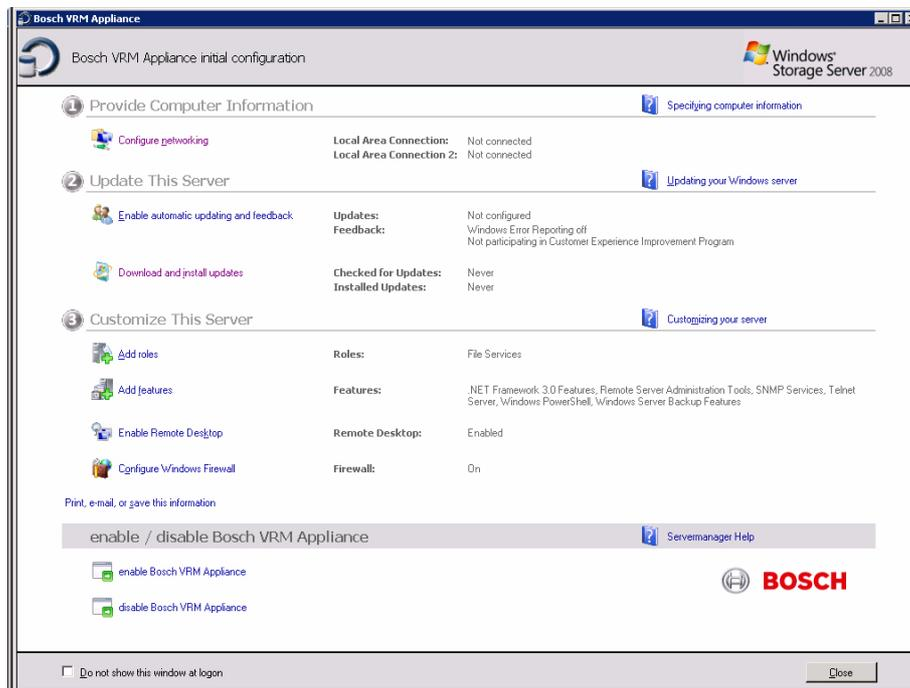
4. La parte superiore della schermata **Bosch VRM Appliance initial configuration** riporta una panoramica della configurazione e delle impostazioni del sistema. Selezionare il collegamento **Configure networking** per accedere alla configurazione di rete. Per ciascuna porta di rete, viene visualizzata un'icona separata. Selezionare l'icona **Local Area Connection** indicante lo stato **network**, quindi fare doppio clic sull'icona.
