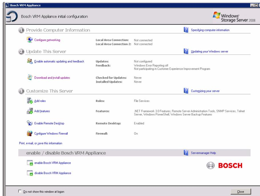
4. De bovenste weergave van **Bosch VRM Appliance initial configuration** is een overzicht van de systeemconfiguratie en -instellingen. Selecteer de link **Configure networking** voor toegang tot de netwerkconfiguratie. Voor iedere netwerkpoort wordt een afzonderlijk pictogram weergegeven. Selecteer het pictogram **Local Area Connection** (geeft de status **network** weer) en dubbelklik op het pictogram.
