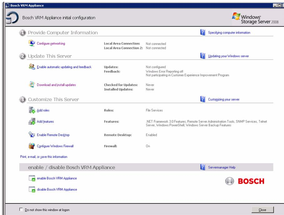
4. La partie supérieure de l'écran **Bosch VRM Appliance initial configuration** affiche une vue d'ensemble de la configuration et des paramètres du système. Cliquez sur le lien **Configure networking** pour accéder à la configuration réseau. Pour chaque port réseau, une icône distincte s'affiche. Cliquez sur l'icône **Local Area Connection**, qui affiche l'état **network**, puis double-cliquez sur l'icône.
