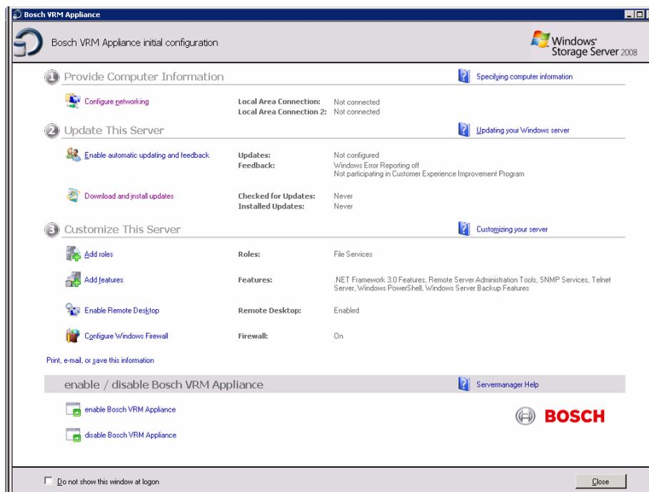
5. **Bosch VRM Appliance initial configuration** で最初に表示される画面には、システムの構成と設定の概要が表示されます。リンク **Configure networking** を選択し、ネットワーク設定を表示します。
