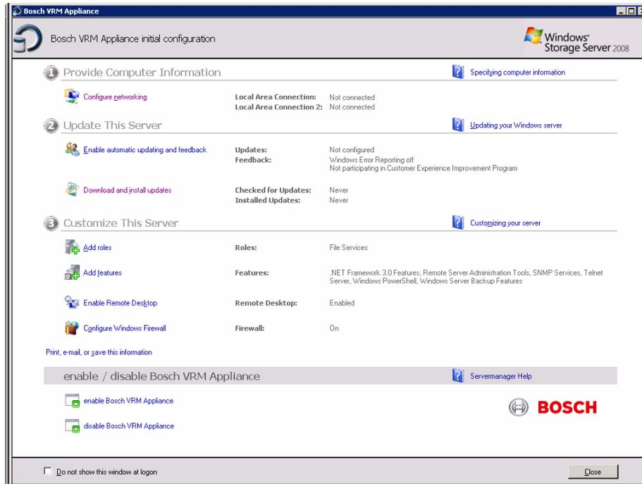
5. Die oberste Ebene von **Bosch VRM Appliance initial configuration** zeigt einen Überblick der Konfiguration und der Einstellungen des Systems an. Wählen Sie den Link **Configure networking** aus, um Zugriff auf die Netzwerkkonfiguration zu erhalten. Für jeden Netzwerkanschluss wird ein eigenes Symbol angezeigt. Wählen Sie das Symbol **Local Area Connection** aus, das den Status **network** anzeigt, und doppelklicken Sie dann auf das Symbol.
