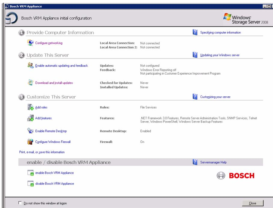
4. **Bosch VRM Appliance initial configuration** で最初に表示される画面には、システムの構成と設定の概要が表示されます。リンク **Configure networking** を選択し、ネットワーク設定を表示します。ネットワークポートごとに、アイコンが個別に表示されます。**network** のステータスの **Local Area Connection** アイコンを選択し、ダブルクリックします。
