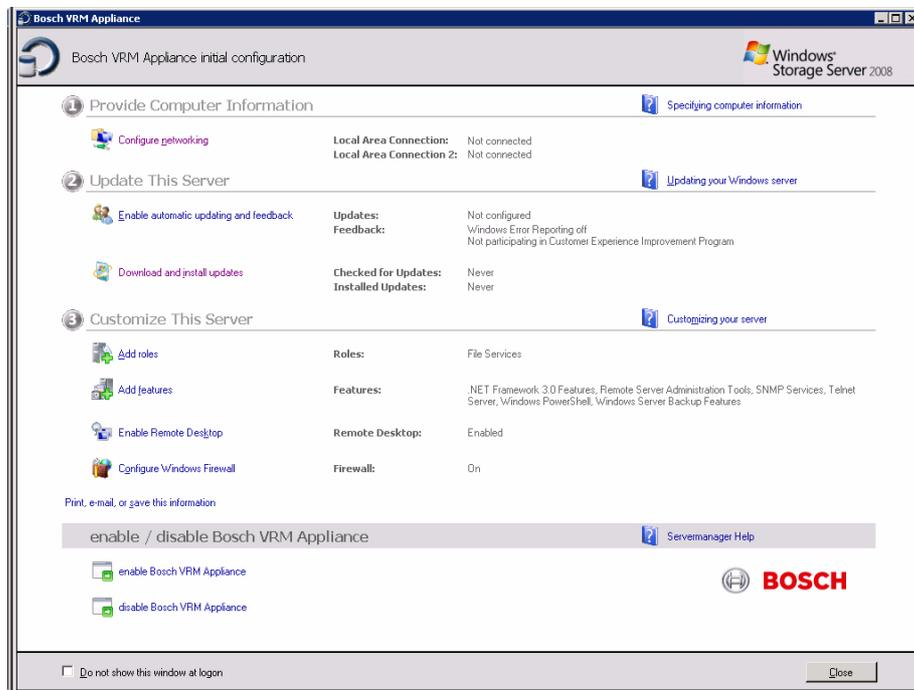
4. **Bosch VRM Appliance initial configuration** 的顶层视图概要显示了系统的配置和设置。选择链接 **Configure networking** 以访问网络配置。对于每个网络端口，均会显示单独的图标。选择用于显示状态 **network** 的 **Local Area Connection** 图标，然后双击图标。
