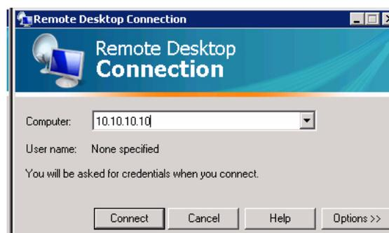
3. 在显示磁盘阵列登录窗口后，单击 **Connect**，按下 **Ctrl+Alt+Del**（如果显示），然后键入默认密码 **WSS4Bosch**。
