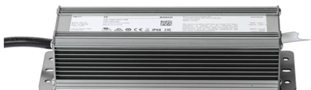
Источники питания PSU-IIR с выходным напряжением 24 В пост. тока предназначены для применения в системах светодиодного освещения. Они обладают защитой от короткого замыкания, перенапряжения, перегрузки по току и перегрева. Каждое устройство имеет кабельные соединения с разделанным проводом длиной 200 мм (8 дюймов).
