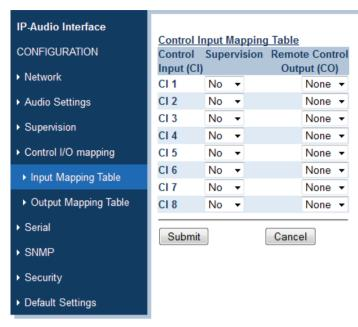
Figure 6.9: Control Input Mapping Table screen (default)
