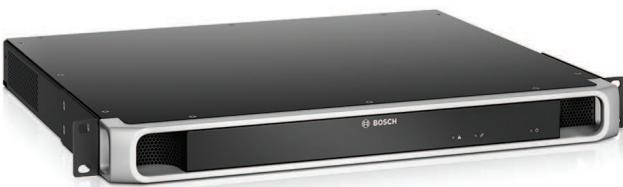
在众多系统控制器中，PRA-SCL是功能最为强大的版本。该系统控制器可管理PRAESENSA公共广播和语音报警系统中的所有与系统相关功能。它可在联网的PRAESENSA音源和目标分区之间路由所有音频连接。它可监测和播放存储在闪存上的信息和提示音，您可以预设定时播放，也可以在呼叫站或PC上手动启动。它可管理背景音乐流的路由、业务呼叫和紧急呼叫，所有这些均根据优先级和分区占用情况而定。它可收集联网系统设备的所有状态信息，管理事件日志，并报告故障。该系统控制器通过OMNEO实现网络连接，并借助带有集成式备用电池的多功能电源进行直流供电，支持集中式和分散式系统拓扑。该系统通过内置的支持RSTP的5端口交换机与其它设备进行连接。借助内置Web服务器，可使用浏览器对系统进行配置。
