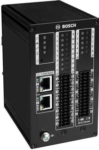
Modul antarmuka Kontrol PRA-IM16C8 menambahkan input kontrol yang dapat dikonfigurasi dan diawasi, output kontrol bebas tegangan, dan output pemicu yang diawasi ke sistem PRAESENSA. Input dan output kontak ini menyediakan konektivitas logika yang mudah dari sistem PRAESENSA ke peralatan tambahan seperti sistem alarm kebakaran, strobo, indikator, atau relai speaker.
