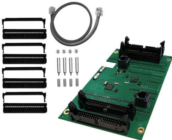
Das Sprechstellenerweiterungskit ist eine Sprechstellenerweiterungsplatine zur Realisierung vollständig kundenspezifischer Sprechstellen und Bedienpanels für PRAESENSA Beschallungssysteme. Das Erweiterungskit lässt sich an das Basis-Sprechstellenkit PRA-CSBK anschließen und bietet die gleichen Funktionalitäten wie zwei PRA-CSE Systemkomponenten ohne die integrierten Tasten und Anzeigen.
