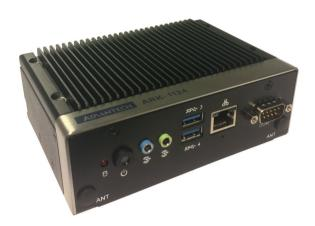
PRA-APAS — это промышленный компьютер с предварительно установленным программным обеспечением, который действует как сервер для PRAESENSA. Он предоставляет расширенные функции речевого оповещения для бизнеса без компромиссов и, следовательно, не поддерживает аварийные функции.
