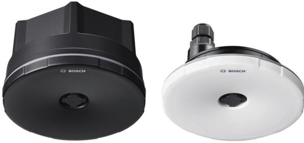
PRA-ANS 是環境噪音感測器，用於監測不斷變化的環境噪音水準，以自動調整廣播或背景音量 (AVC - 自動音量控制)。這確保了公共廣播的音訊設在高於環境噪音的可配置音量，以保證廣播的清晰性，且音量大小達到舒適度。
