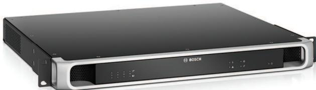
這是彈性且精簡的多頻道功率放大器，適用於公共廣播及語音警報應用場所的 100 V 或 70 V 揚聲器系統。它可完美融入集中式系統拓撲，但也支援分散式系統拓撲（因為它擁有 OMNEO IP 網路連線），並可結合多功能電源供應器的 DC 電源。
