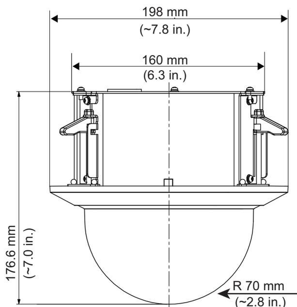
Abb. 1: Modell für Deckeneinbau
