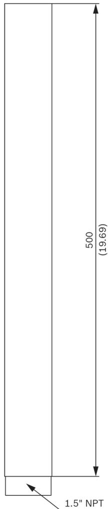
Abb. 1: Abmessungen NDA-U-PMTE (lange Rohrverlängerung)
