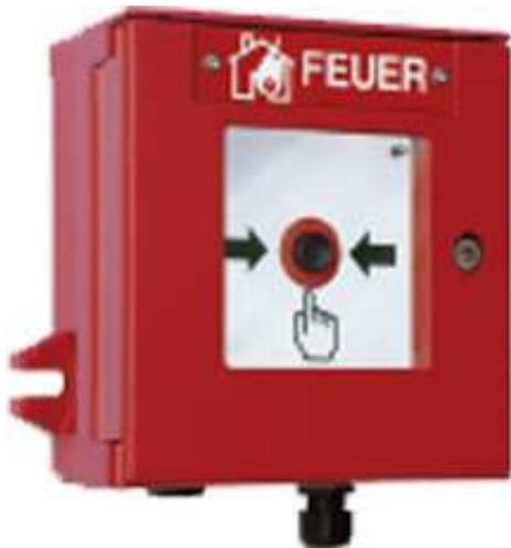
I pulsanti vengono utilizzati per attivare manualmente l'allarme nelle zone 1, 2, 21 e 22 a rischio di esplosione. Sono incapsulati in modo da non richiedere alcuna barriera di sicurezza.
