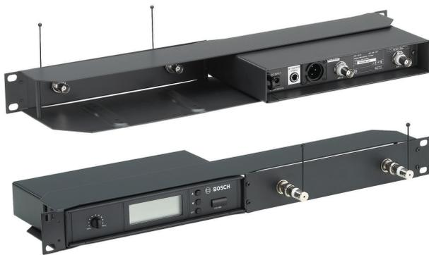
Este kit permite montar los receptores de micrófono inalámbrico MW1-RX-Fx en racks de 19 pulg. Se pueden montar dos unidades, una junto a la otra, en un espacio de rack de una unidad de altura. Si sólo se utiliza una unidad, la otra mitad del bastidor se puede ajustar con el panel suministrado, en el que se pueden montar las dos antenas. Éstas se conectan al receptor mediante los dos cables BNC suministrados.
