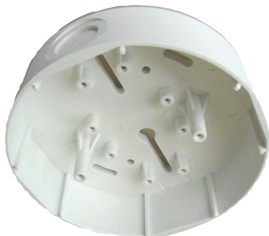
La base adicional MSC 420 se ha creado especialmente para cableados de superficie con conductos de protección de cables y tiene 2 entradas opuestas perforadas previamente de 20 mm de diámetro y 2 entradas adicionales opuestas y preparadas para un diámetro de hasta 28 mm.
