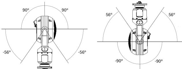
**그림 1: MIC IP fusion 9000i 카메라 틸트 범위**
