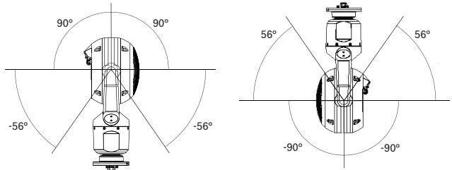
図. 1: MIC IP fusion 9000iカメラのチルト範囲
