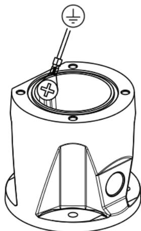
6. Schroef groene GND-draad van camerasokkel aan aardingsopening in binnenwand van DCA. Als DCA niet wordt gemonteerd op geaard oppervlak, door gebruiker te leveren bevestiging dan geaarde draad (onderdeel 4 in stap 1) aan hetzelfde aansluitpunt.
