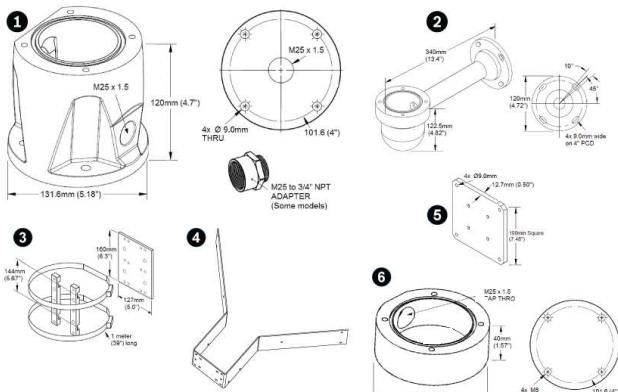
Рис. 1: Дополнительные кронштейны, серия MIC IP 7100i
