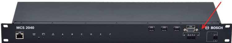
Bild 6.1: Reset-Taster an der MCS 2040 Servereinheit
