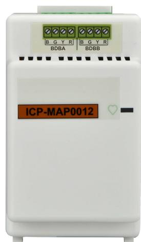
Dispositivo hardware opzionale che sdoppia un Bosch Data Bus (BDB) in due linee indipendenti e isolate per la connessione di tastiere, gateway e altri alimentatori. In questo modo è possibile ottenere un cablaggio flessibile in differenti direzioni con una lunghezza massima di 500 m e una superiore affidabilità.
