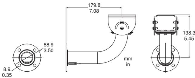
LTC 9215/00S 短型墙壁支架，适合室内使用
