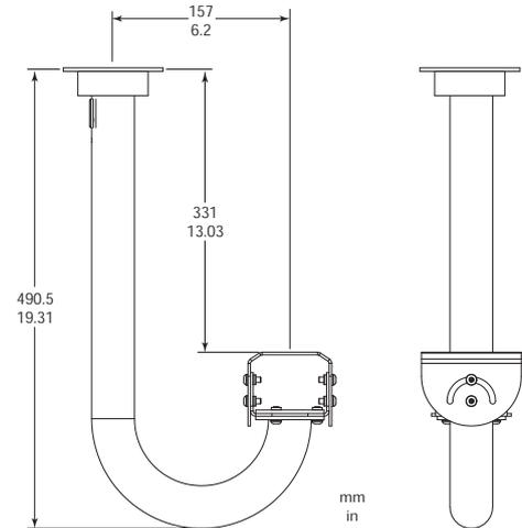
J-образный кронштейн со сквозной проводкой LTC 9219/01 для использования внутри помещений
