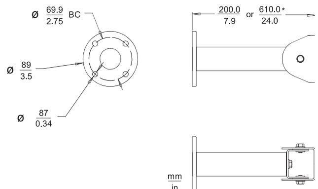
LTC 9210/01 e LTC 9223/01 Suporte de montagem em coluna para utilização no interior
