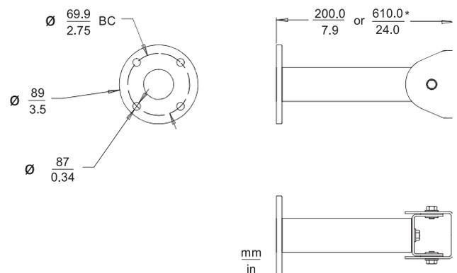
Soportes para montaje sobre columna LTC 9210/01 y LTC 9223/01 para uso en interiores
