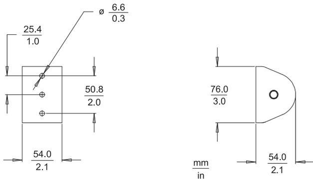
Esquema de dimensiones del cabezal ajustable
