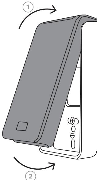
6. Крутите винт снизу считывателя в обратном направлении, чтобы закрепить его на установочной пластине.
