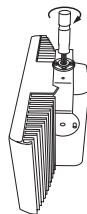
Hình 5.7: Gắn chốt của chân đỡ trên sàn vào giá treo của bộ bức xạ
