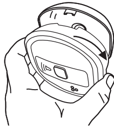
Figure 6.3: Détachement du détecteur
