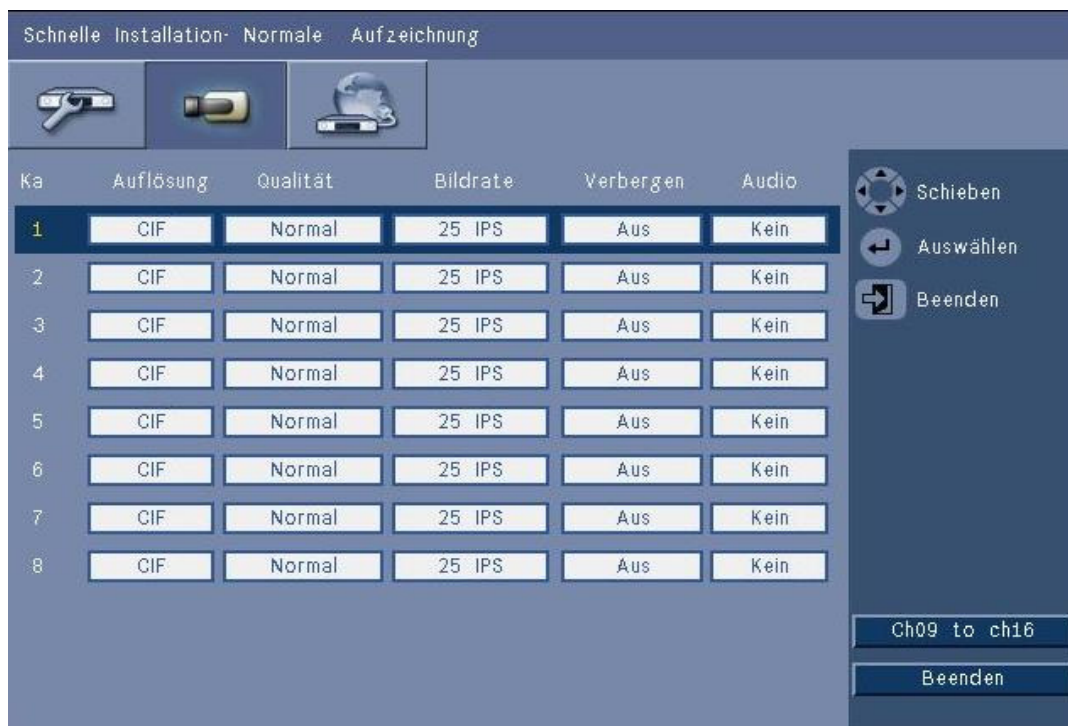
Bild 3.4 Quick install (Schnellinstallation) – Fortlaufende Aufzeichnung Stellen Sie für jedes in der Tabelle angezeigte Profil Auflösung, Qualität, Bildwiederholrate, Verbergen und Audio für den fortlaufenden Aufzeichnungsmodus ein.
