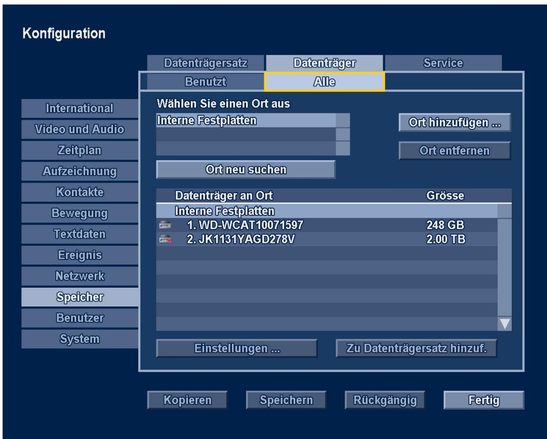
Bild 6.26 Konfigurationsmenü – Speicher – Datenträger – Alle
