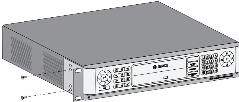
**Bild 4.2** Befestigung der Rackmontagehalterung
