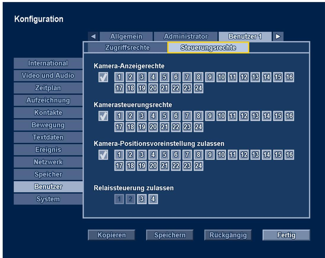
**Bild 6.29** Konfigurationsmenü – Benutzer – Steuerungsrechte von Benutzer 1
