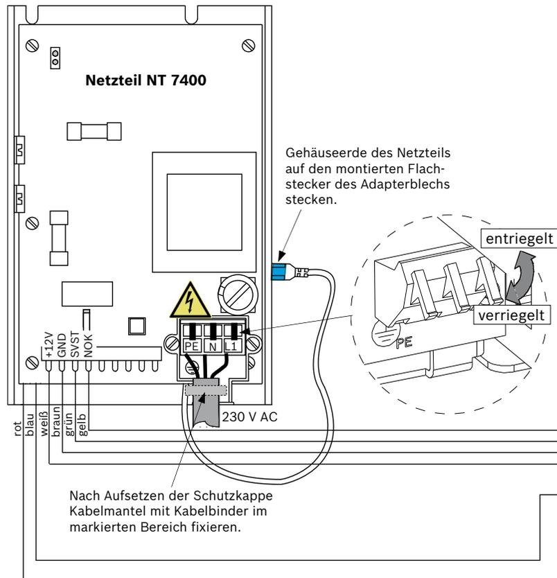
Gehäuseerde des Netzteils auf den montierten Flachstecker des Adapterblechs stecken.
