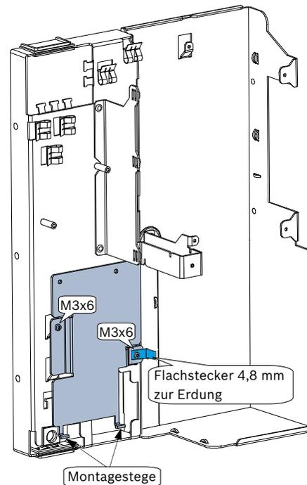
2. Netzteil in die Montagestege des Adapterblechs einsetzen und mit beiliegenden Schrauben (2 x M4x10) befestigen.
