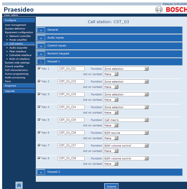
Abbildung 43.28: Konfiguration von Fernsprechstellen, Schritt 7
