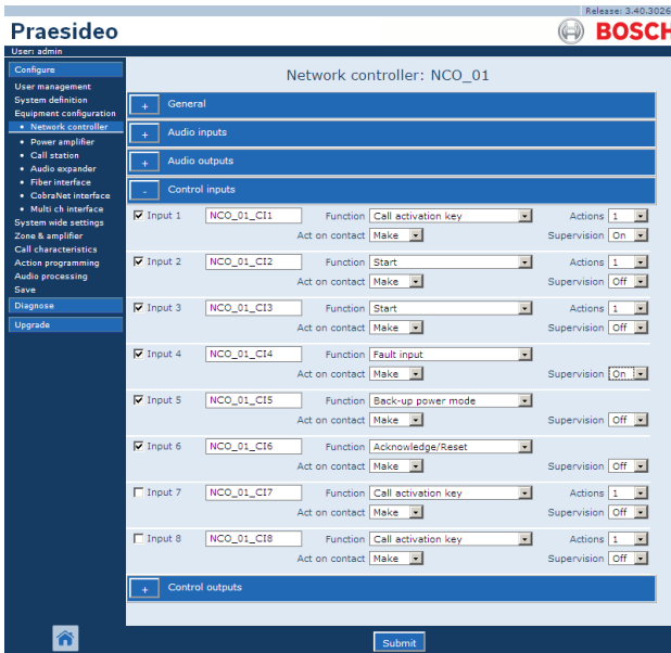
Abbildung 43.7: Netzwerkcontroller konfigurieren, Schritt 5
