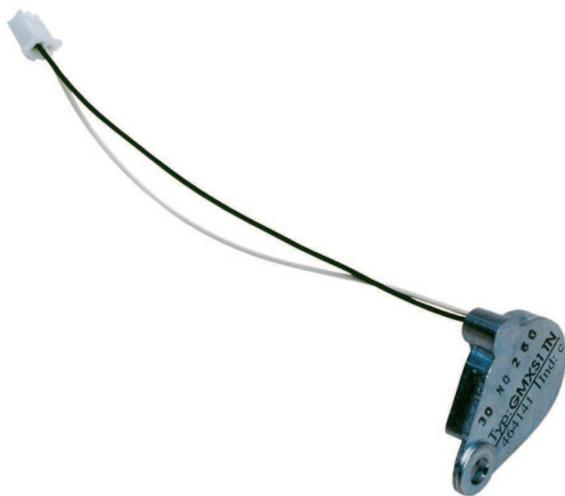
Der Prüfsender ISN-GMX-S1 ist ein Bestandteil des Testsystems für den Körperschallmelder. Er wird in unmittelbarer Nähe des Melders platziert und durch den integrierten Prüfgenerator angesteuert. Durch den Einbau des Prüfsenders ist es möglich, sowohl die Körperschall-Leitfähigkeit der mechanischen Befestigungen als auch die Funktionsfähigkeit der Elektronik zu prüfen.
