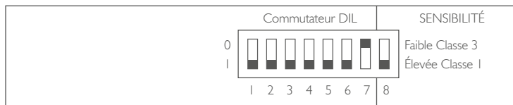
Figure 10. Commutateurs DIL avec couvercle avant du détecteur retiré (réglages d'usine normaux illustrés)
