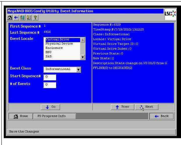
Das VD-Ereignis meldet zuerst einen herabgestuften Status (degraded), anschließend einen Offline-Status. Die als erstes ausgefallene Festplatte (first failed) war die in der Rebuild-Phase befindliche PD 4. Als PD 6 ausfiel, wurde der Rebuild gestoppt; als PD 4 defekt war, schaltete das RAID-Array offline.
