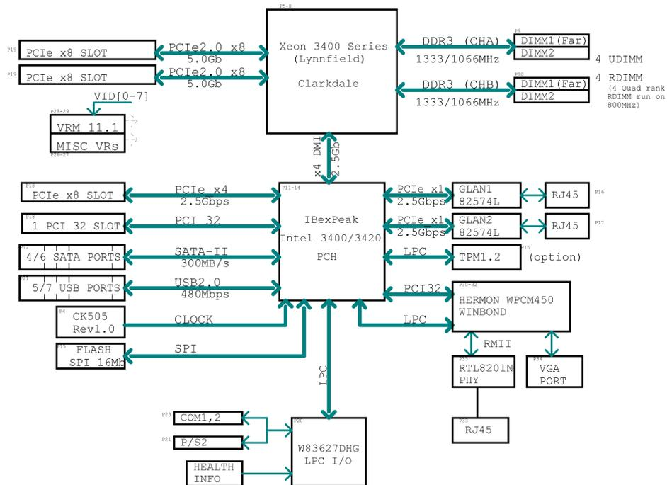
Bild 5.3: Blockdiagramm
