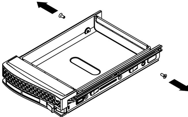
2. Entfernen Sie den Laufwerksdummy aus dem Festplattenträger.
