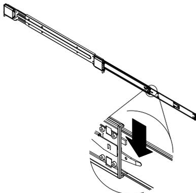
4. Trennen Sie die innere Auszugsschiene von der äußeren Schienenvorrichtung.
