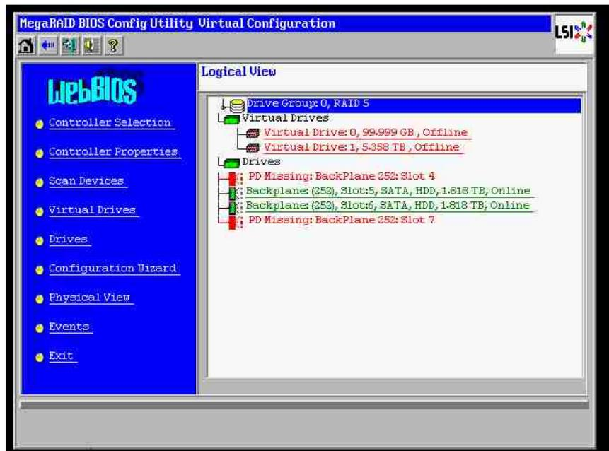
Der Rebuild könnte nur starten, wenn die anderen drei Festplatten zuvor online waren: die Rebuild-Festplatte ist als erste ausgefallen (first fail), das herabgestufte RAID (degraded) befand sich in der Rebuild-Phase. Die „fremde“ Festplatte (foreign) ist die als zweites ausgefallene Festplatte (second fail), eine der Festplatten, von der die Paritätsdaten vor dem Ausfall auf die Rebuild-Festplatten kopiert wurden.
