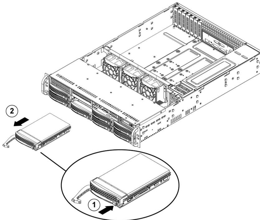
2. Ziehen Sie das Laufwerk mit dem Griff aus dem Gehäuse.
