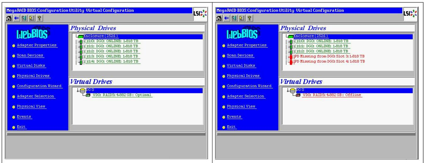
Prinzipiell schreibt der RAID-Controller die RAID-Konfigurationsinformationen (COD = Configuration-On-Disk) auf jeder vom Controller verwalteten Festplatte in ein einzelnes Feld. Der Datenbereich einer Festplatte wird davon nie verwendet, unabhängig davon, wie oft die RAID-Konfiguration geschrieben und gelesen wird. Mit den Konfigurationsoptionen „Neu“ bzw. „Löschen“ werden die COD-Informationen, sofern verfügbar, gelöscht.
