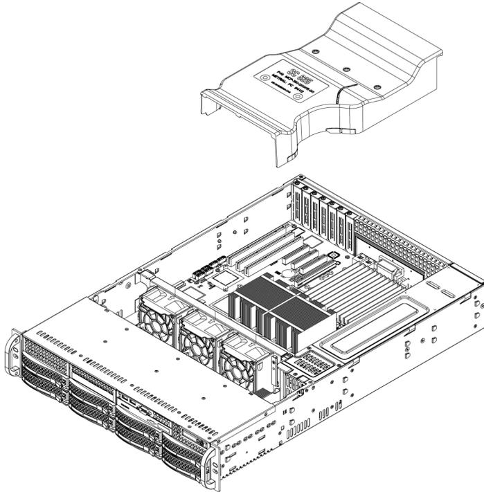
Luftleitkanäle bündeln den Luftstrom, um die Lüfterleistung optimal zu nutzen. Für den Einbau des Luftleitkanals werden keine Schrauben benötigt.
