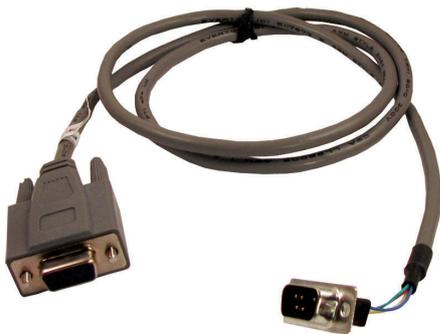
Das Serielle Kabel MAP ermöglicht die Verbindung zwischen MAP DE-Modul und Übertragungseinheit oder MAP-Modem (GPRS-MAP0008). Es besteht aus einem 1,6 m langen, grauen Kabel mit PVC-Ummantelung mit einem DB9-Anschlussstecker an beiden Enden.
