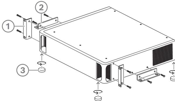
그림 6.4: 19인치 랙, 평평한 표면 및 피트 장착
