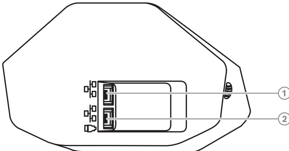
그림 4.5: DICENTIS 장치 (DCNM-D / DCNM-DVT / DCNM-DSL / DCNM-DE) 하단면
