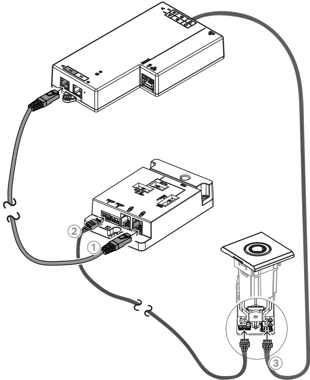
**그림 7.11:** DCNM-FAI를 통해 DCNM-FMCP를 DCNM-FBD2에 연결
