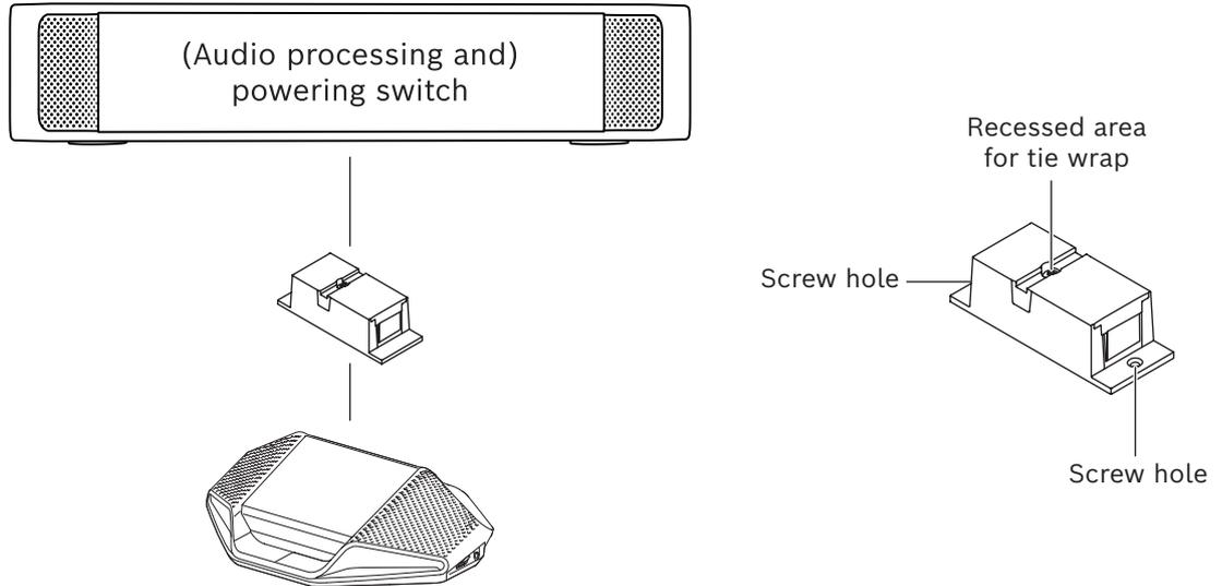
그림 5.2: 플로어 포드에 브레이크아웃 박스로 설치
