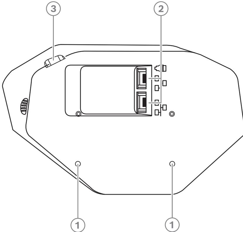
그림 7.2: DICENTIS 장치(DCNM-D / DCNM-DVT / DCNM-DSL / DCNM-DE) 하단면
