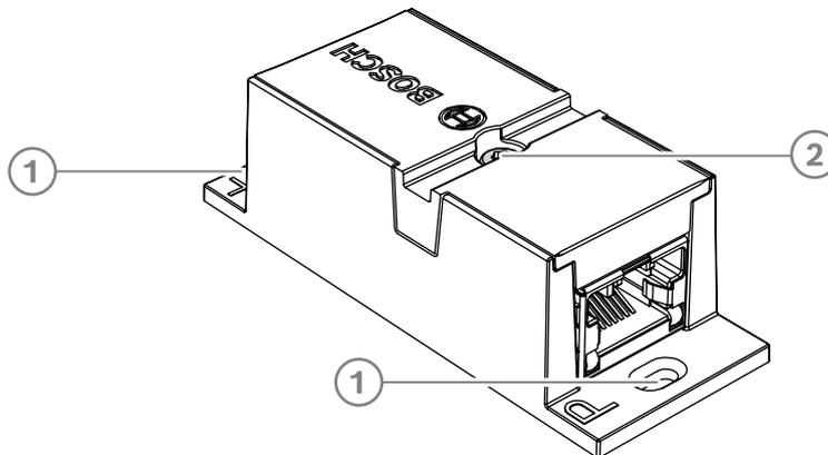
DCNM-CBCPLR을 평평한 표면에 고정하려면 플랩(1)의 기존 구멍에 2개의 2.5mm 나사를 삽입합니다. 기존 홈(2)을 이용해 케이블 타이를 감아 측면 움직임을 방지하여 DCNM-CBCPLR을 고정할 수도 있습니다.
