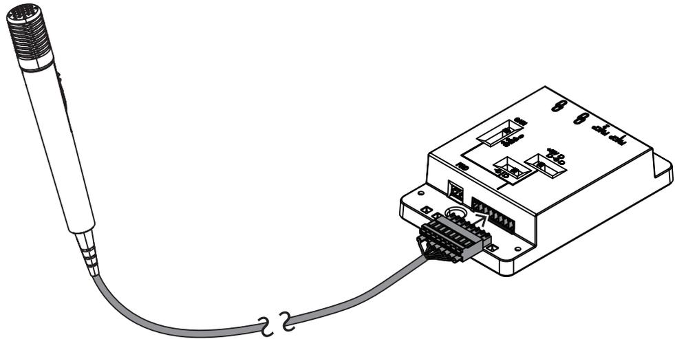
그림 7.13: DCNM-FAI를 DCNM-FHH/DCNM-FHHC에 연결
