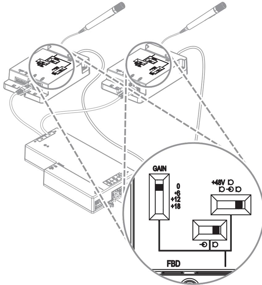
그림 7.14: DCNM-FHH/DCNM-FHHC 연결을 위한 DCNM-FAI 스위치 설정
