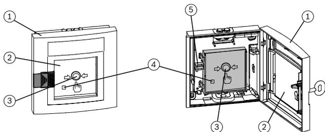
Em caso de alarme, quebre o painel de vidro (2) primeiro e, em seguida, pressione o botão de alarme manual (3) com força. Isso ativará o microinterruptor para acionamento do alarme, e o LED indicador (4) piscará. Um mecanismo mantém o botão de alarme pressionado.
