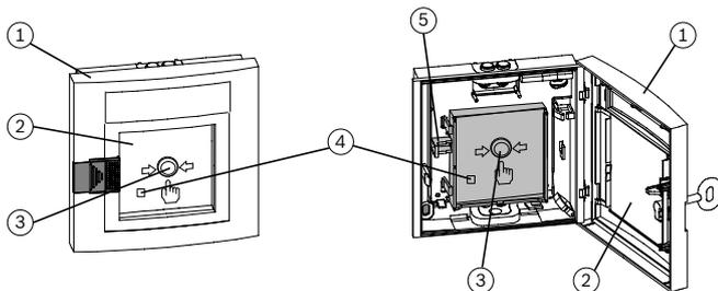
При необходимости включения аварийного сигнала сначала разбивается стекло (2), затем сильно нажимается ручной извещатель (3). В результате активируется микропереключатель тревоги и начинает мигать светодиодный индикатор (4). Блокирующий механизм удерживает утопленную кнопку.
