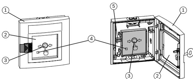
En caso de alarma, primero se rompe el panel de cristal (2) y, a continuación, se presiona el pulsador de alarma (3) con fuerza. Esto activa el microinterruptor para la activación de alarmas y el indicador LED (4) parpadea. Un mecanismo mantiene el pulsador de alarma presionado.
