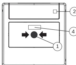
Durch Eindringen der schwarzen Markierung (1) wird der Alarm ausgelöst. Der Alarmzustand wird durch das markierte Sichtfenster (4) und die blinkende LED-Anzeige (2) angezeigt.
