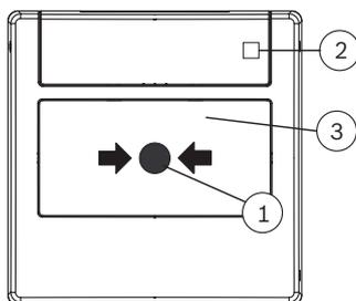
Durch Eindringen der schwarzen Markierung (1) bricht die Glasscheibe (3), der Alarm wird ausgelöst und die LED-Anzeige (2) blinkt.
