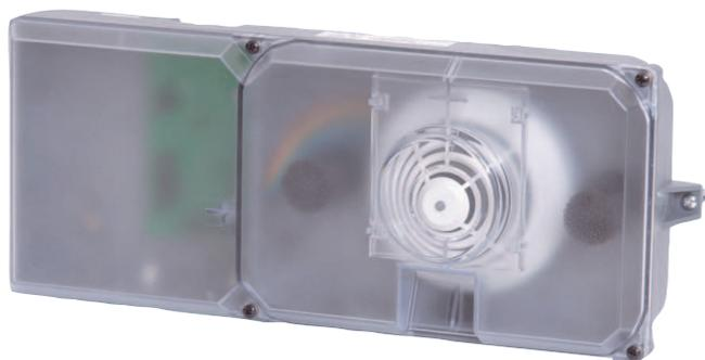
L'alloggiamento del rivelatore condotti FAD-420-HS-EN con base e rivelatore FAD-425-O-R integrato, rileva il fumo nei condotti di ventilazione. Le particelle di fumo presenti nell'aria vengono rivelate e segnalate in modo affidabile alla FACP dal sistema bus LSN improved.
