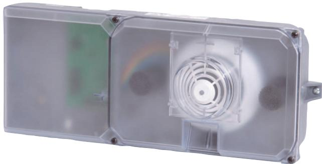
Το πλαίσιο ανιχνευτή για αεραγωγούς FAD-420-HS-EN με βάση και ενσωματωμένο ανιχνευτή FAD-425-O-R ανιχνεύει καπνό σε αεραγωγούς εξαερισμού. Τα σωματίδια καπνού του αέρα ανιχνεύονται και αναφέρονται με αξιοπιστία στον πίνακα πυροπροστασίας από το σύστημα διαύλου με βελτίωση LSN.
