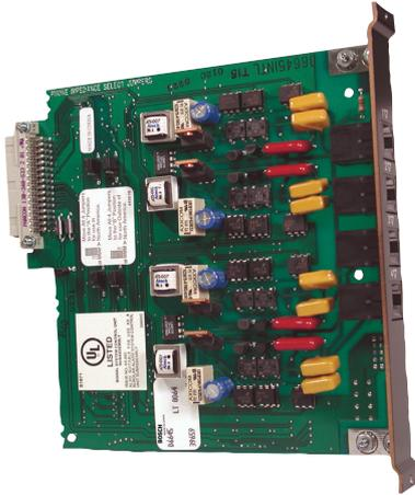
模块化设计插入式电路板。对 Conettix D6641 电话线路卡提供隔离和瞬时抑制。提供四个模块化 RJ11 插孔，用于电话线连接。
