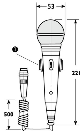
尺寸 (单位: 毫米), 显示壁装支架 (1)
