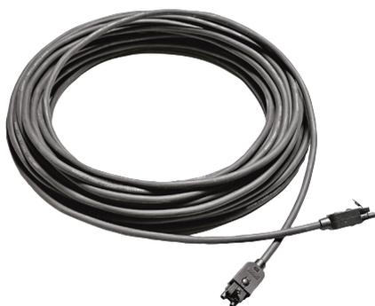
这是一种特制的电缆，包含用于数据和音频通信的 2 根塑料光纤和用于供电的 2 根铜芯。该电缆交货时已装配了网络连接器。此电缆可用于将 CCU 连接至音频扩展器。网络电缆的长度各有不同。产品编号的附加部分 (/xx) 代表电缆的长度。只有 LBB 4416/00 未带连接器。连接器 (LBB 4417/00) 需要单独订货。
