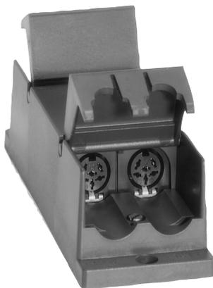
分配器用于在主干线路上创建短路保护分流点。每个分流点最多允许连接五个通道选择器面板或一个桌面馈送装置，如讨论装置、Concentus 装置或译员台等。一个分配器包含两个分流点。分配器附带完整的线束夹，并且包含用于固定的安装孔。
